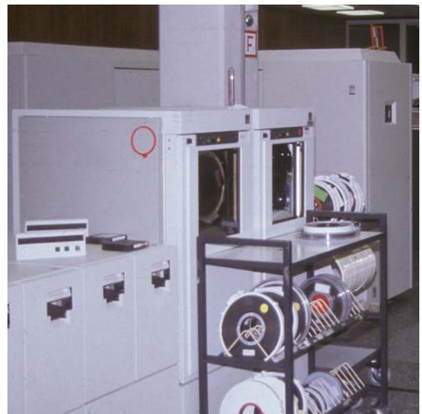
**Abb. 4: Magnetbandgeräte der IBM 3090: links Kassetten-Laufwerke IBM 3480, rechts Spulen-Laufwerke IBM 3422**
